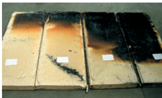
Minimalni doprinos jezgra širenju požara. Unutar panela između površinskih slojeva ne dolazi do širenja plamena. Sl.
