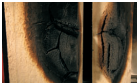
Ugljena naslaga se stvara samo u delovima direktno izloženim plamenu i ne dolazi do širenja požara.
